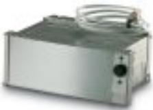
Kasten-Kältespeicher-Verdampfer für Horizontal- oder Vertikaleinbau, Leitungslänge bis ca. 2 m, **nur im verbinding mit Kühlaggregat** mehrfach dichtenden Schraubkupplungen, für Kühlrauminhalte 110 Liter bei PU-Isolierung von 35 mm, Thermostatregelung stufenlos einstellbar
