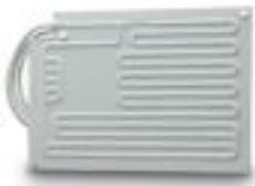
Plattenverdampfer - Leitungslänge ca. 3m, Optional mit mehrfach dichtenden Schraubkupplungen, für Kühlrauminhalte bis 80 Liter bei PU-Isolierung von 35 mm,Optional Thermostatregelung stufenlos einstellbar und extern montierbar
