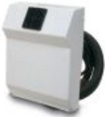
Umluftverdampfer - Leitungslänge ca. 2,5 m, Optional mit mehrfach dichtenden Schraubkupplungen, für Kühlrauminhalte bis 200 Liter bei PU-Isolierung von 35 mm, Optional Thermostatregelung stufenlos einstellbar und extern montierbar
