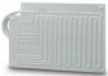
Plattenverdampfer - Leitungslänge ca. 3 m, Optional mit mehrfach dichtenden Schraubkupplungen, für Kühlrauminhalte bis 110 Liter bei PU-Isolierung von 35 mm, Optional Thermostatregelung stufenlos einstellbar und extern montierbar
