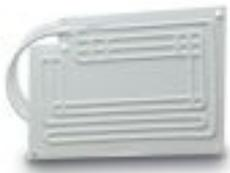
Plattenverdampfer - Leitungslänge ca. 2,5 m, Optional mit mehrfach dichtenden Schraubkupplungen, für Kühlrauminhalte bis 30 Liter bei PU-Isolierung von 35 mm, Optional Thermostatregelung stufenlos einstellbar und extern montierbar
